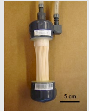
Figure 2. Exemple de module membranaire à échelle réduite utilisé lors des études en laboratoire réalisées dans le cadre de ce projet de recherche
